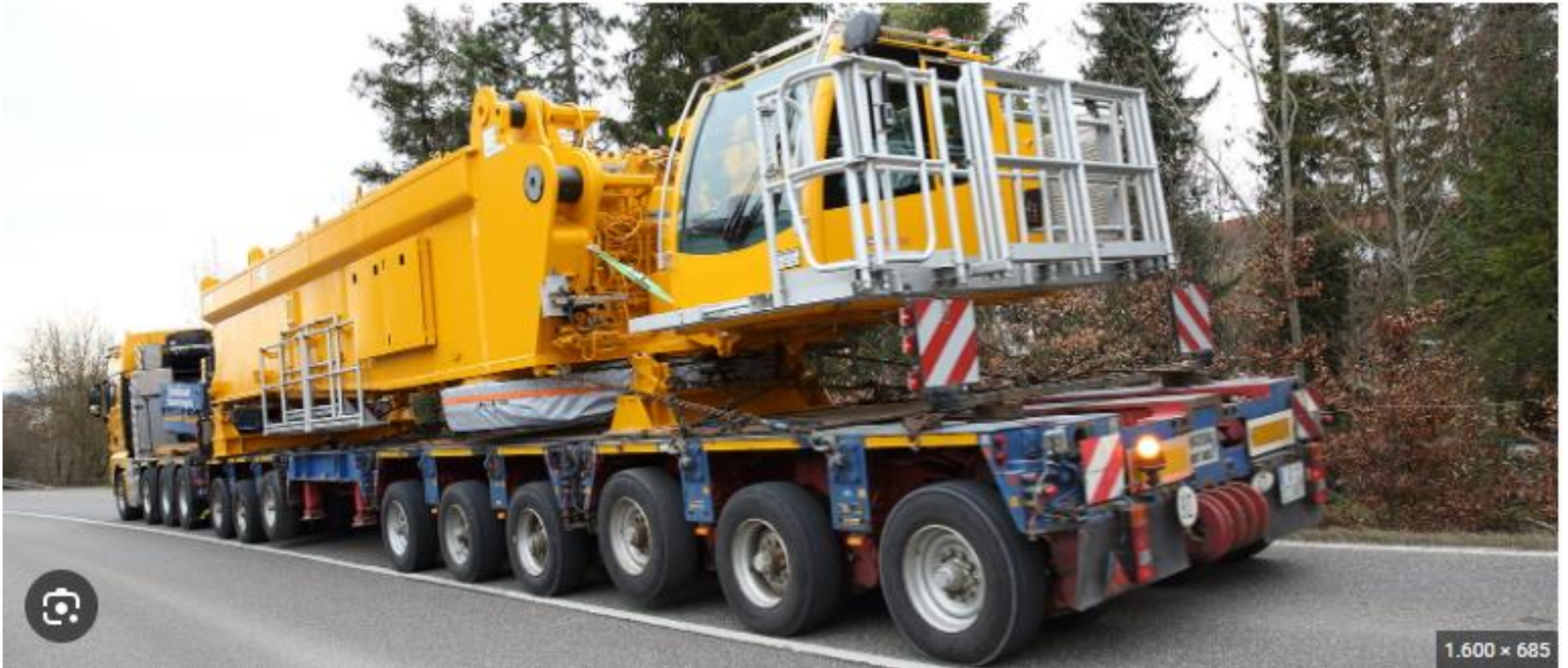
Antransport Liebherr LR 1800, 800 to Raupenkran, Unterwagen ohne Raupen Bild: Deutschland
